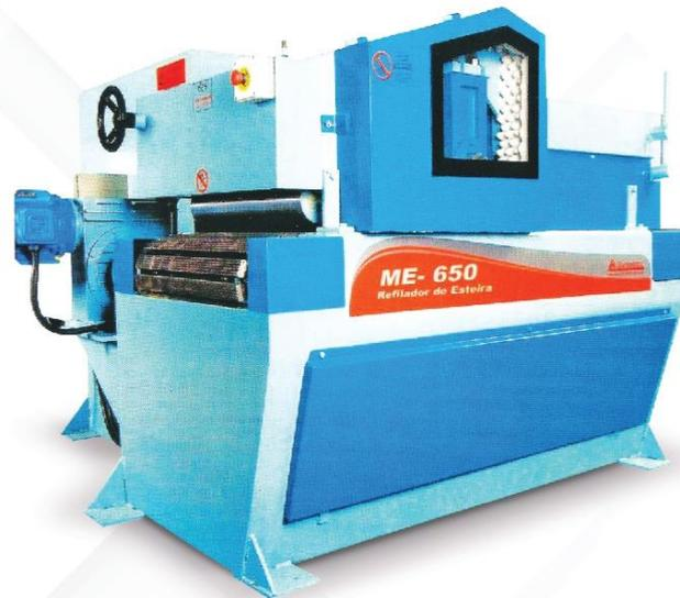
Multi sierra de un eje superior y avance por cinta transportadora con la finalidad de refilar la madera.
