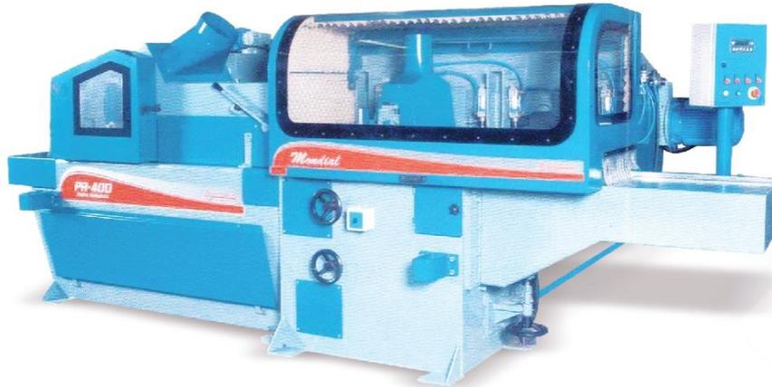
Posee un sistema para cepillar y refilar la madera en una solo operación.
